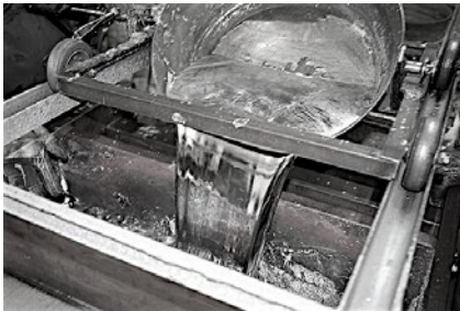
Die Zinn-Legierung wird geschmolzen
