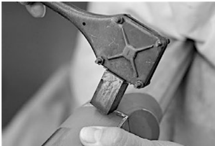
Die Zinnplatten werden von Hand gehobelt, geschnitten und zu Pfeifen zusammengelötet
