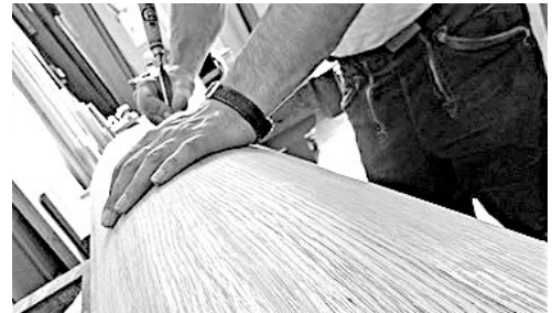
Aufwändige Bearbeitung der runden Gehäuseteile aus Eichenholz
